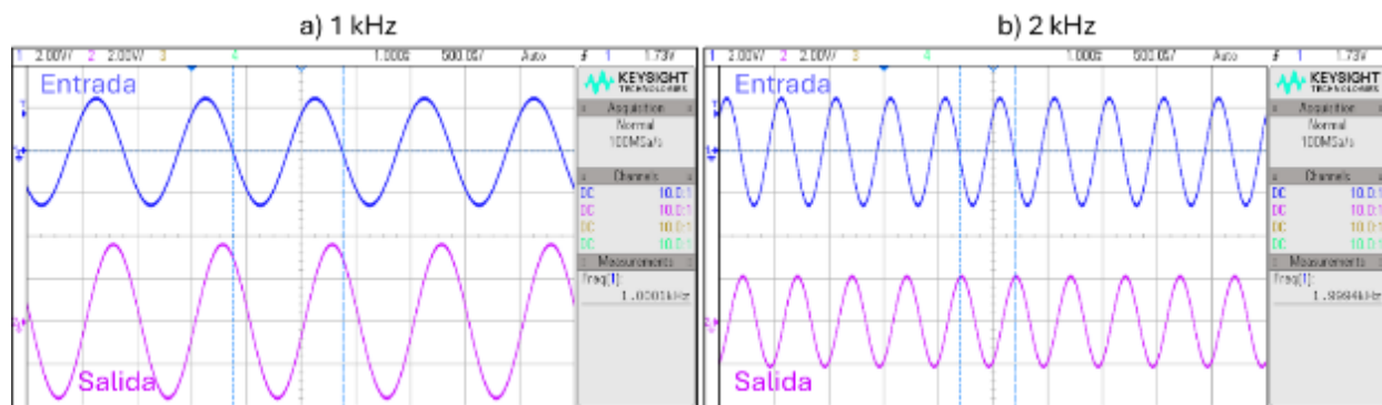
Figura 6. Ejemplo de la respuesta en frecuencia de un amplificador vista en un osciloscopio (elaboración propia).
