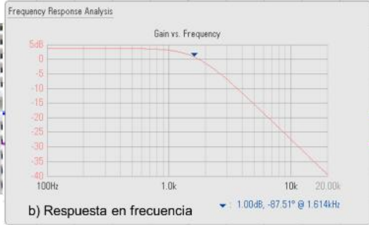
Figura 20. Respuesta en frecuencia de un filtro Sallen-Key de componentes iguales (elaboración propia).
