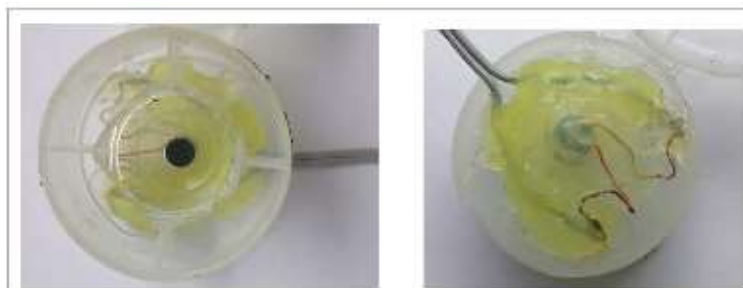
Figura 14. Sensor acústico, visto por ambos lados y sin membrana (elaboración propia).
