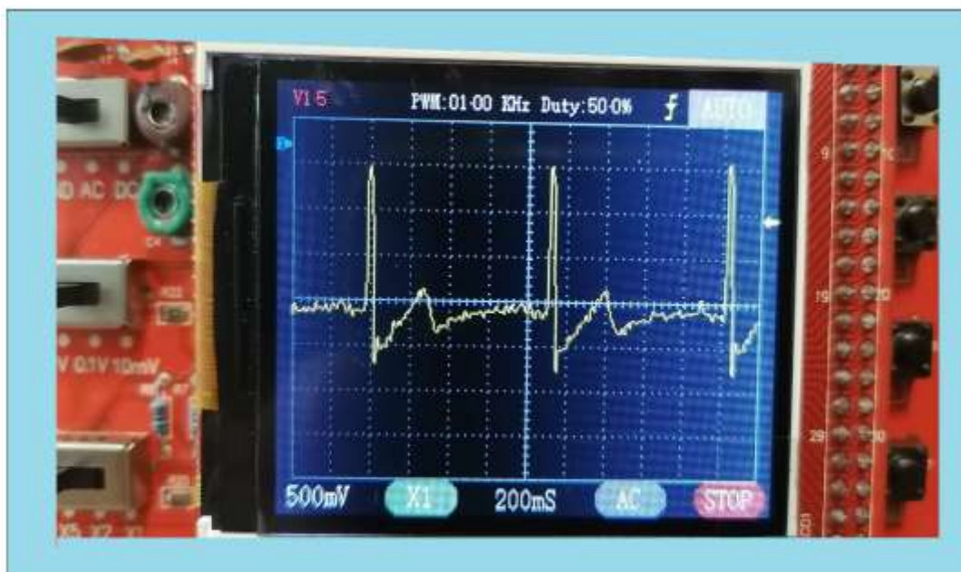
Figura 28. ECG típico obtenido con el prototipo (elaboración propia).
