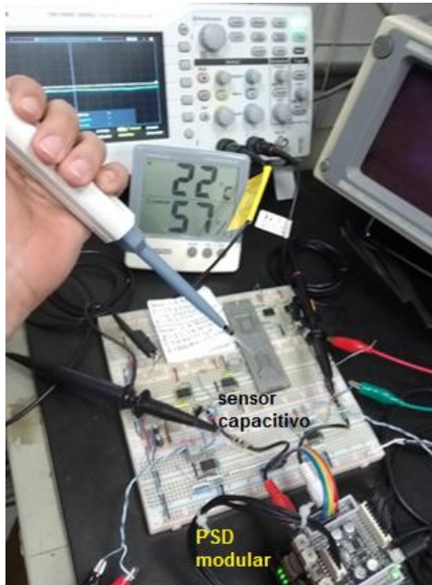
Figura 18. Prueba del sistema basado en el PSD con muestra de líquido solvente, (elaboración propia).
