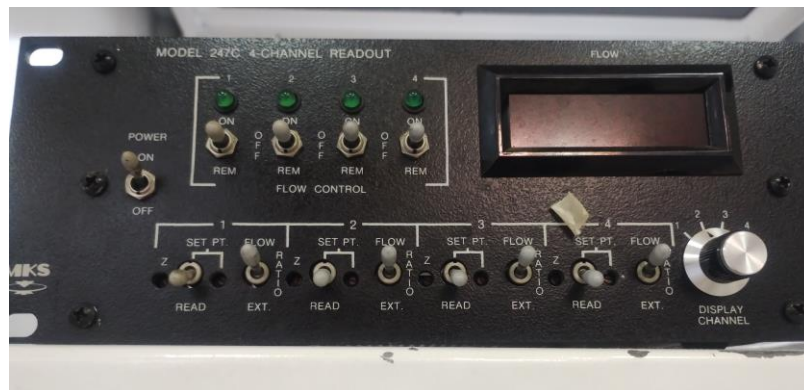
Figura 2. Sistema de control de flujo de gases: a) Controlador de flujo, b) Fuente alimentación (Elaboración propia)
