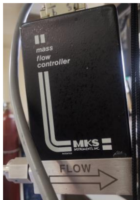
Figura 2. Sistema de control de flujo de gases: a) Controlador de flujo, b) Fuente alimentación (Elaboración propia)
