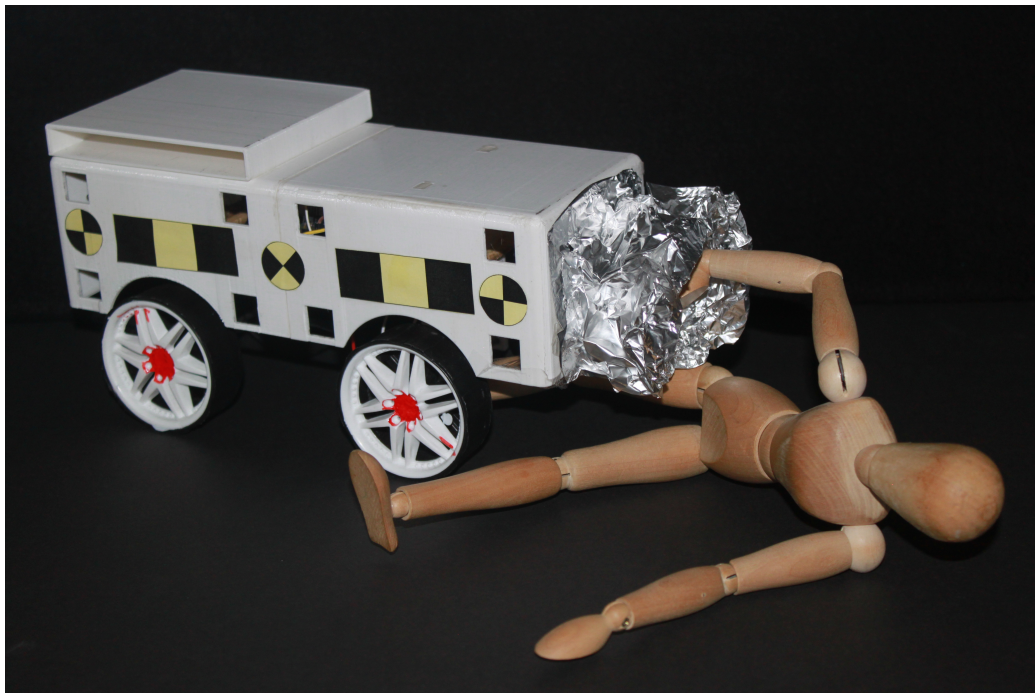
Figura 57.1: Modelo experimental de atropellamiento. Fotografía del autor. La fotografía muestra un modelo de carrito de colisiones con una parte frontal deformable. El modelo permite variar su centro de masa y velocidad para registrar efectos de colisiones.
