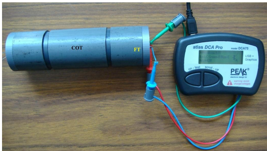
Figura 2.12. Arreglo experimental para caracterizar el FT en oscuridad con la COT y con el generador de curvas (Fuente: elaboración propia).
