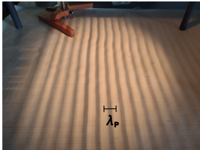
Figura 5.2. Patrón de ondas proyectadas sobre una superficie debajo de la cuba de ondas, obtenido con la cámara de un celular. En la figura se indica la longitud de onda (elaboración propia).
