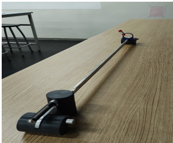
Figura 6.3. Arreglo experimental. La muestra está a 1 m de láser y al fondo, a más de 2.70 m se encuentra la pantalla con papel milimétrico (elaboración propia).
