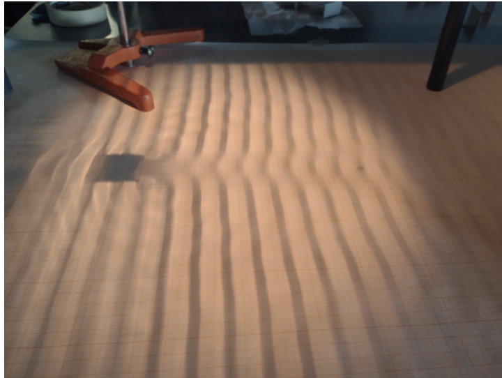
Figura 5.3. Imagen de la difracción por curvatura de un frente de onda plano cuando pasa por un objeto (elaboración propia).
