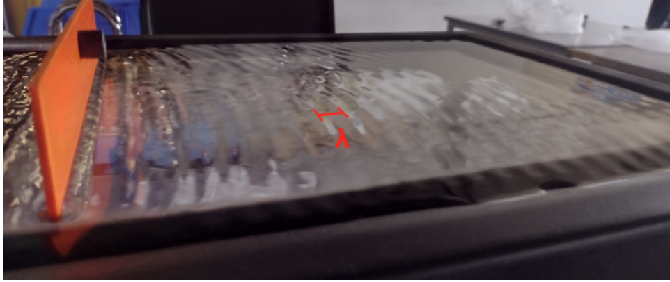
Figura 5.1. Fotografía donde se observan frentes de onda paralelos y aproximadamente rectos de las ondas en el agua en una cuba de ondas (elaboración propia).
