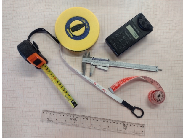
Figura 4.1. Instrumentos para medir longitudes o distancias: flexómetro, regla, cinta métrica, vernier o calibrador y medidor electrónico de distancias (elaboración propia).
