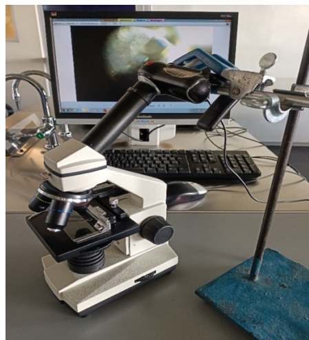
Figura 4.8. Montaje de la cámara web frente al ocular para tomar fotografías (elaboración propia).
