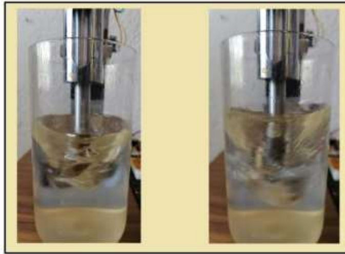
Figura 15. Agitación de un fluido de prueba a dos velocidades diferentes
