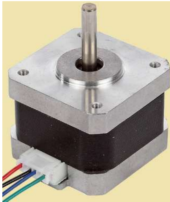
Figura 4. Motor a pasos utilizado en el sistema
