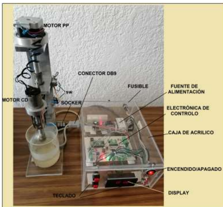
Figura 14. Distribución de elementos eléctricos del sistema
