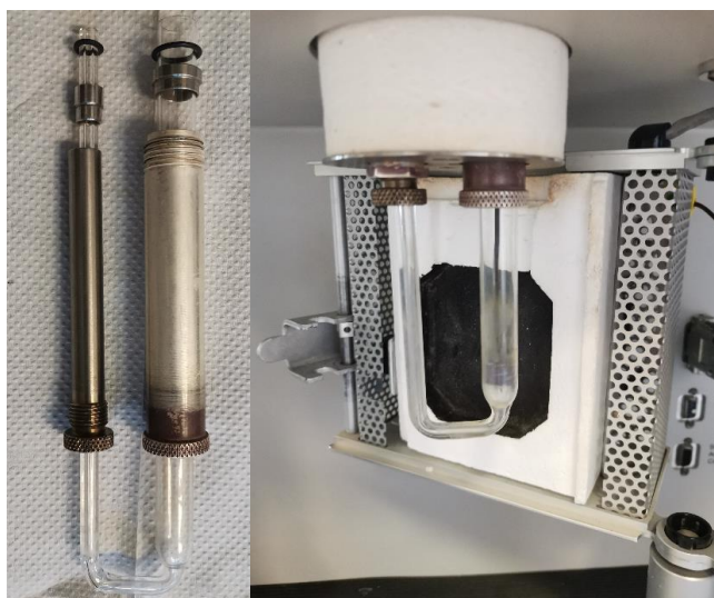
Fig. 4. Ensamble de la celda con muestra en el equipo AutoChem II 2920
