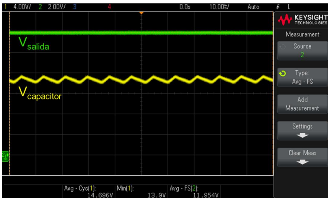
Figura 4. Voltaje de salida y del capacitor de filtrado. Carga = 175 mA (imagen propia).
