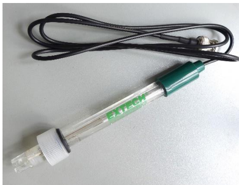
Figura 21. Sonda de medición de pH (imagen propia).
