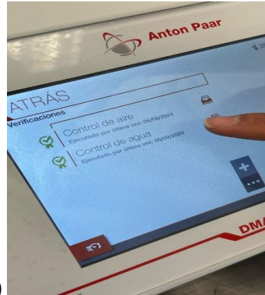
Figura 4. a) Inyección de muestra para verificación de agua b) Pantalla donde se observa la verificación del control de agua Fotografía: De autoría propia
