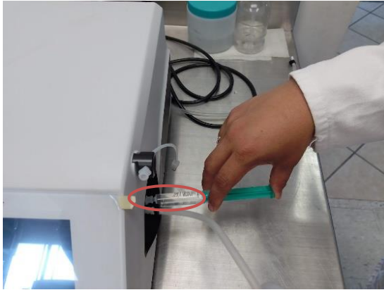
Figura 4. a) Inyección de muestra para verificación de agua b) Pantalla donde se observa la verificación del control de agua Fotografía: De autoría propia
