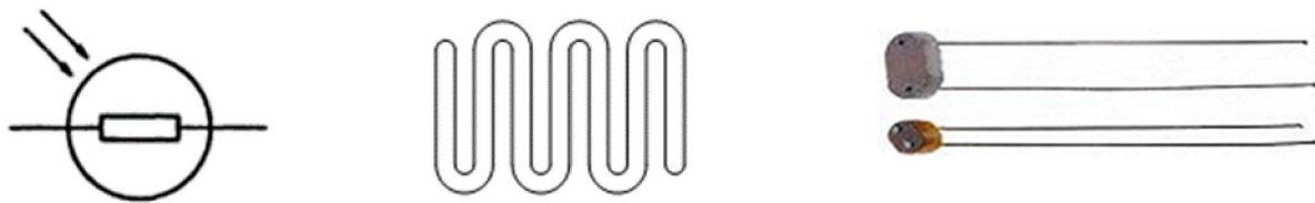
Figura 2.3. Símbolo eléctrico y forma de una fotorresistencia, (Sendra, 2001, p.16).
