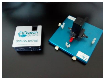
Figura 2. Espectrotómetro Ocean Optic. A la izquierda está el Módulo y a la derecha el portamuestras, ambos cubren una superficie de 30 cm 2 .
