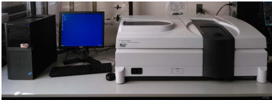
Figura 4. Espectrofotómetro Cary 5000 UV-vis-NIR ubicado en el LUCE (Laboratorio Universitario de Caracterización Espectroscópica) del ICAT.
