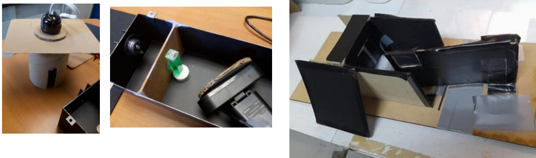
Figura 10. Espectrómetros caseros fabricados con material de reciclaje. Como detector se puede usar la cámara de un celular o una cámara web.
