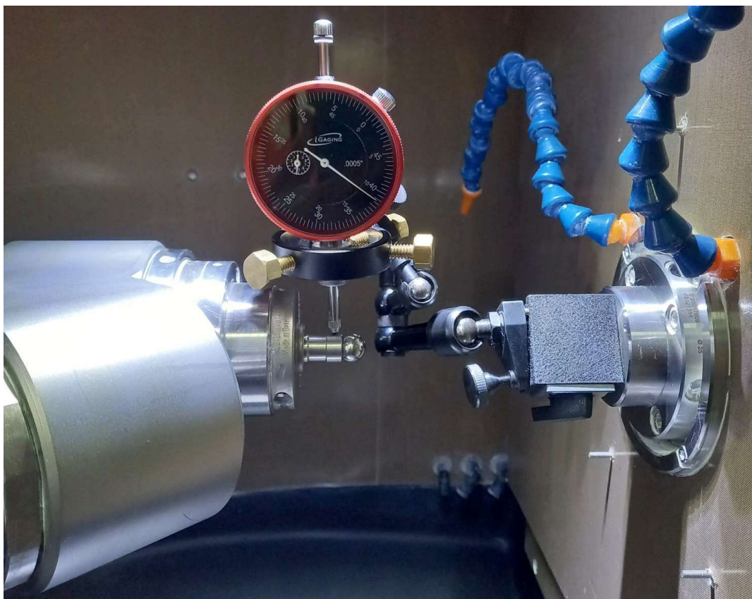
Figura 14. Colocación del palpador para verificar la alineación de los ejes.
