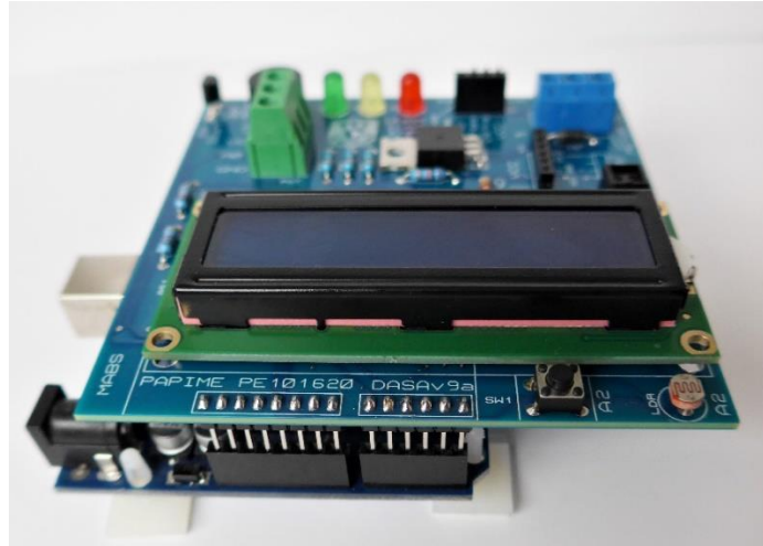
Figura 1. El módulo DASA siendo montado en una placa Arduino UNO.
