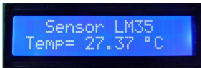
Figura 14. LCD mostrando el valor de la temperatura detectado con el sensor LM35.
