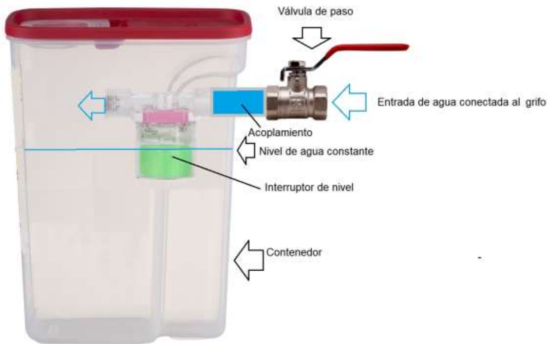
Figura 5. Depósito principal de agua
