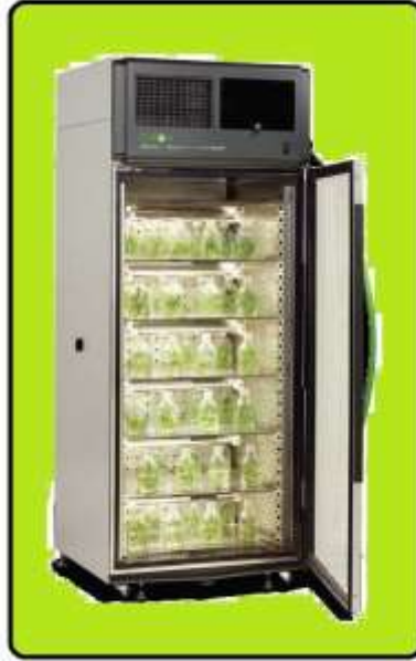
Figura 2. Cámara de almacenamiento para pruebas de vida de anaquel aceleradas
