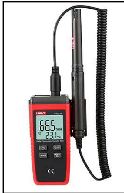
Figura 20. Termohigrómetro utilizado para la verificación de lecturas en la cámara
