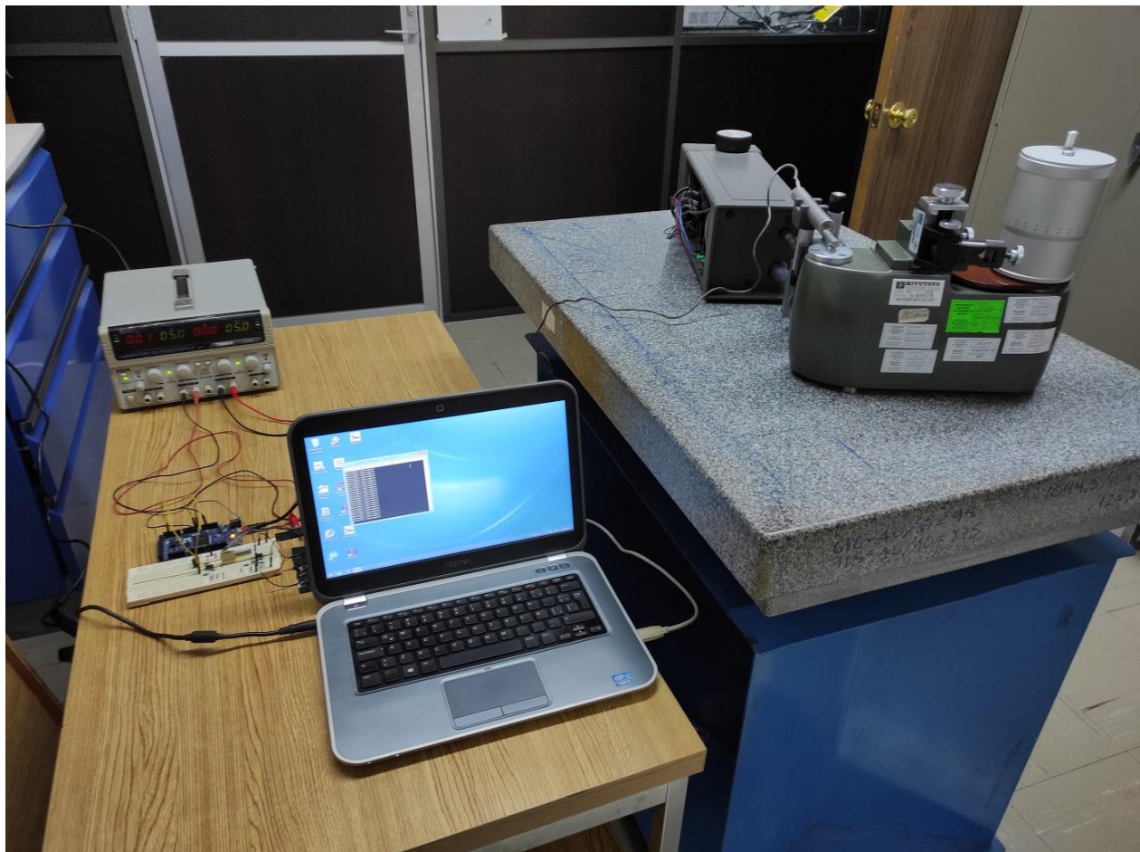
Figura 16. Sistema electrónico para el palpador LVDT.
