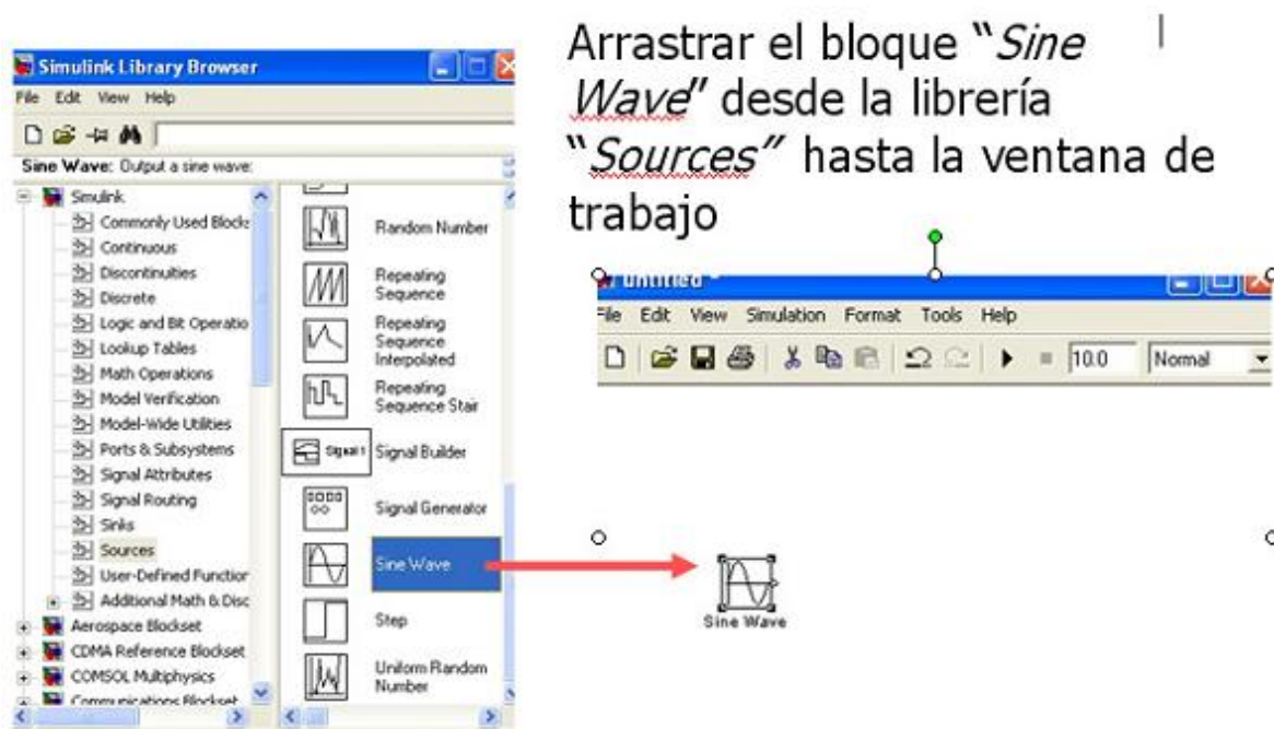
Figura A2. Selección del bloque Sine Wave para utilizarlo en la ventana de trabajo.
