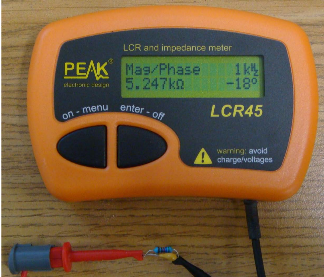
Figura 14. Medidor LCR portátil para estimar experimentalmente los valores de R_m , C_m , Z_m y \theta_m .
