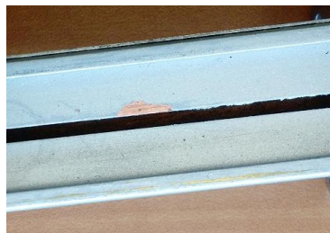
Figura 3. Fotografía del lado ancho de la guía de onda.
