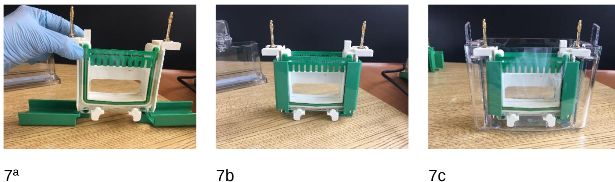
Figura 7. Armado del módulo de electroforesis
