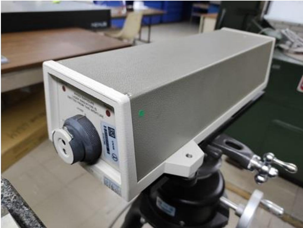
Figura 4. Lámpara láser del HP5528A.
