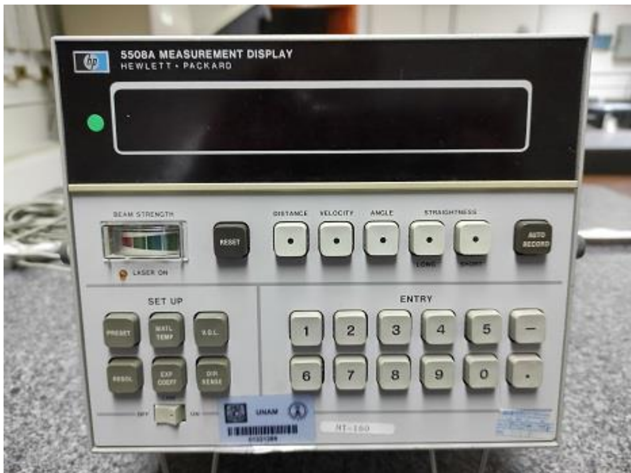
Figura 3. Consola de control del láser HP5528A.
