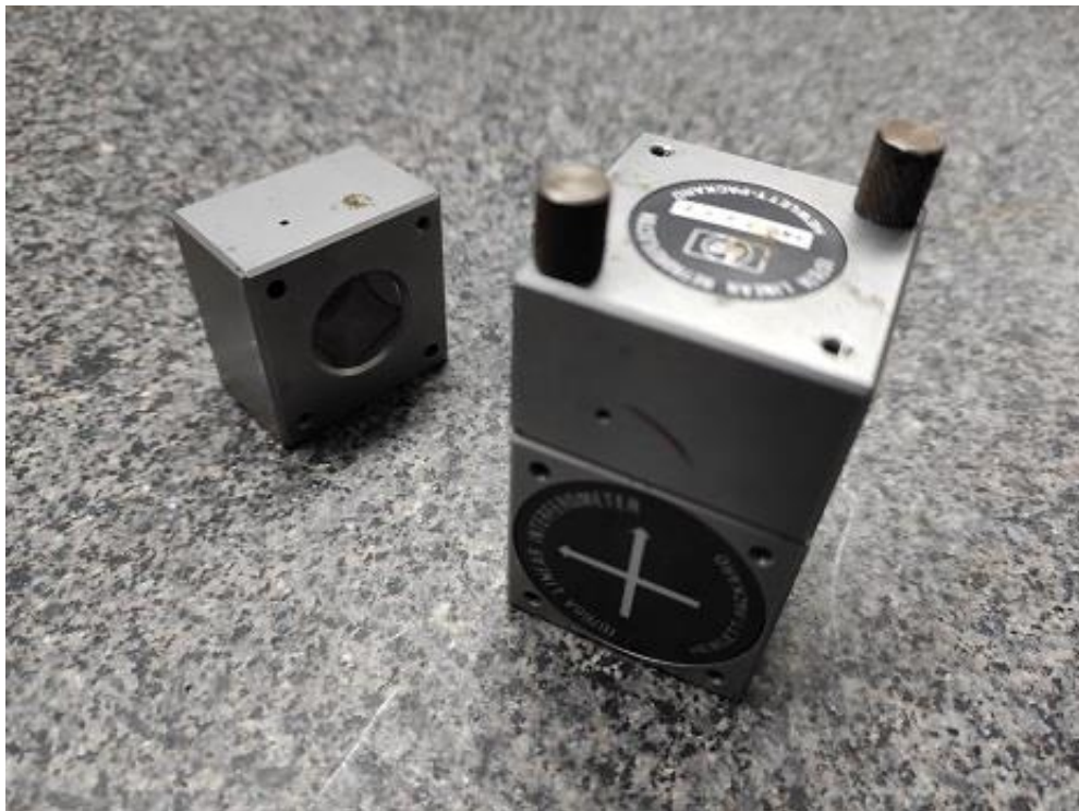
Figura 5. Óptica auxiliar a la medición de longitud.
