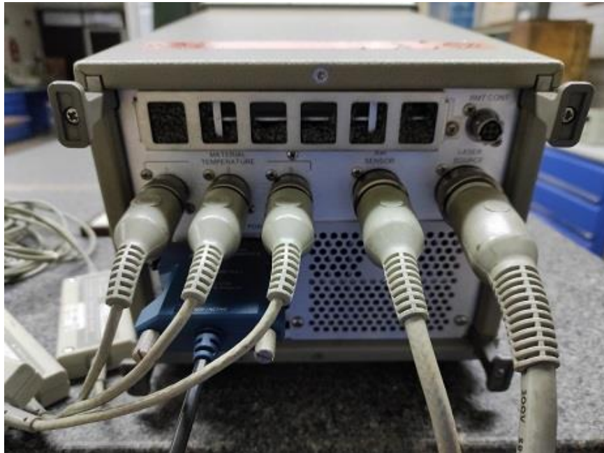
Figura 39. Vista posterior de la consola del láser HP5528A y con conexiones.
