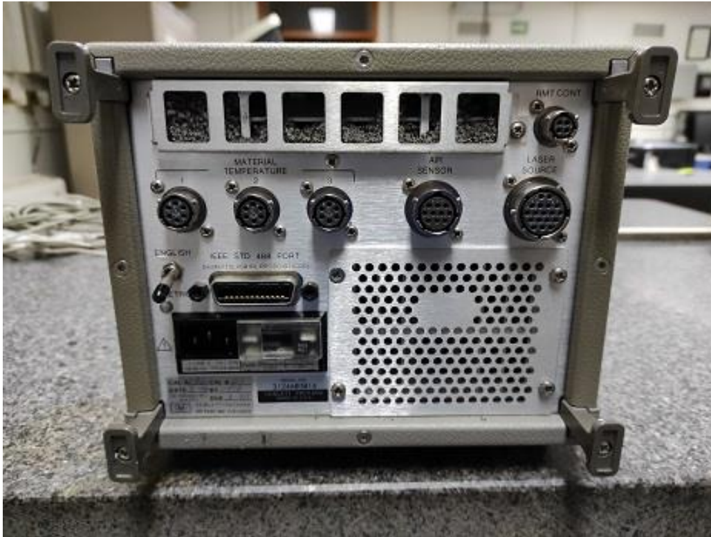
Figura 7. Vista posterior de la consola de control en donde se encuentran localizados los puertos de conexión.
