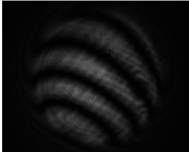
Figura 19: Interferograma experimental obtenido al reducir la distancia de separación entre la superficie de referencia y la superficie de prueba en 50 micras respecto a la posición inicial = 5 cm.
