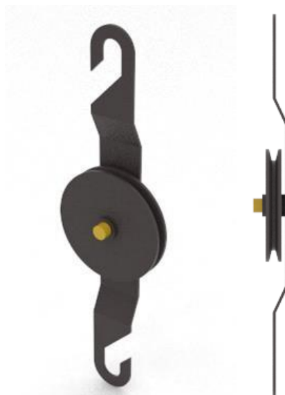
Figura 5. Polea simple, vistas frontal y lateral.
