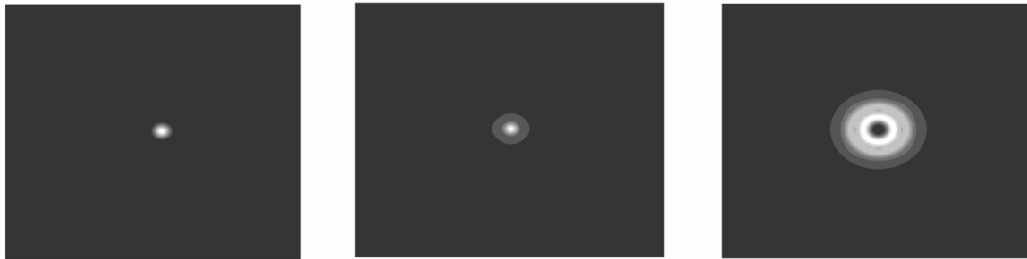
Figura 9.3: Gráficas de la PSF para un sistema óptico con defoco. El valor de A_d es igual a 0, izquierda; 0.5, centro; 1.0, derecha. ( AberacionesObjetoPuntual.m )
