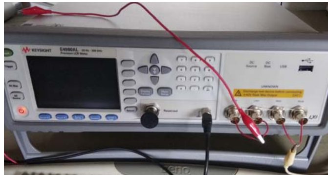
Figura 15. Conexión realizada sin test fixture.
