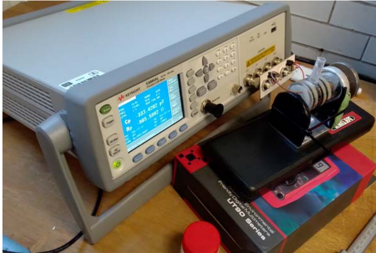
Figura 22. Mediciones realizadas con el sensor capacitivo de placas paralelas.
