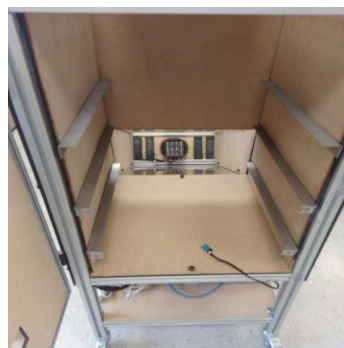
Figura 7. Prototipo construido e instalado. a) Sistemas principales del equipo. b) Colector y sistema de monitoreo y control. c) Cámara de deshidratado.
