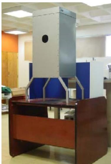
Figura 6. Interferómetro tipo Newton de fabricación en el Centro de Instrumentos UNAM.
