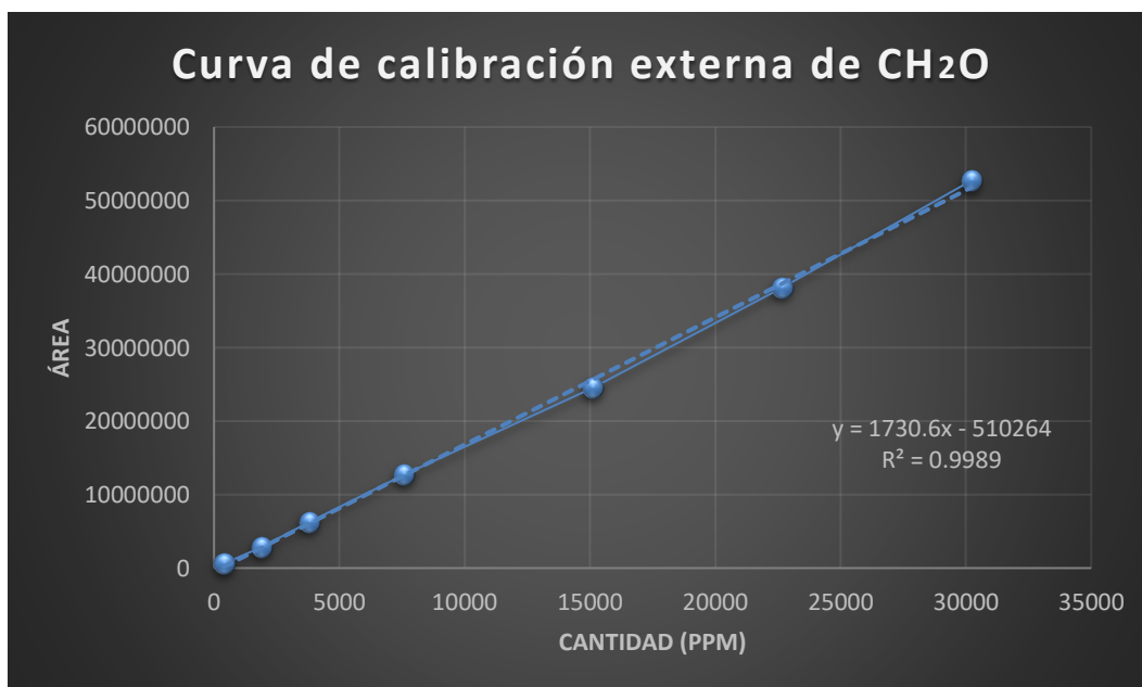
Figura 11. Curva de calibración externa de CH 2 O
