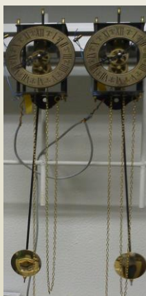
Figura 2.15. Relojes de péndulo colgados de una viga de aluminio, sincronizados en antifase. Tomado de: Oliveira, H. M., & Melo, L. V. (2015). Huygens synchronization of two clocks. Scientific reports , 5, 11548.
