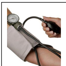
Figura 4.21 Esfigmomanómetro manual. Se muestra la bomba manual y la manguera conectada a la cámara de presión, el manómetro, en este caso, es de manecilla.
