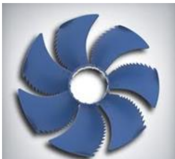
Figura 1.23 Aspas de un ventilador (Ziehl-Abegg) que incorpora el borde de ataque serrado del ala del búho. La reducción de ruido es de 7 dB y es más eficiente en consumo de energía.
