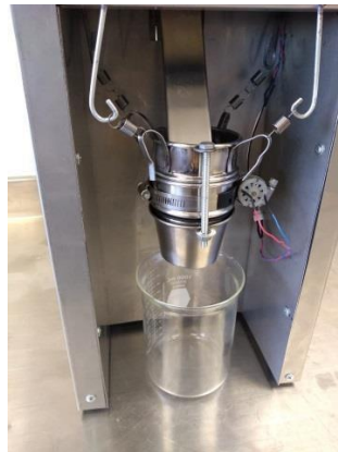
Figura 7. Colocación del recipiente recolector.
