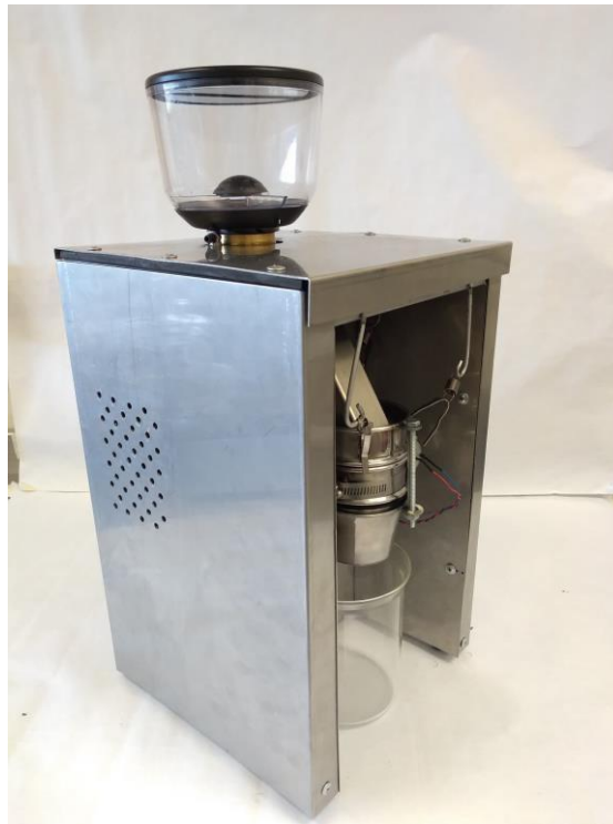
Figura 1. Prototipo de sistema de molienda y tamizado
