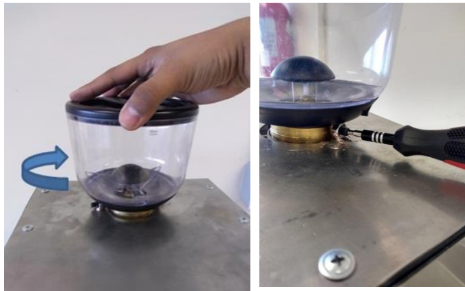
Figura 6. Ajuste de la tolva de alimentación.
