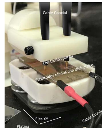
Figura 7. Montaje completo del Sensor Capacitivo de Doble Sonda.
