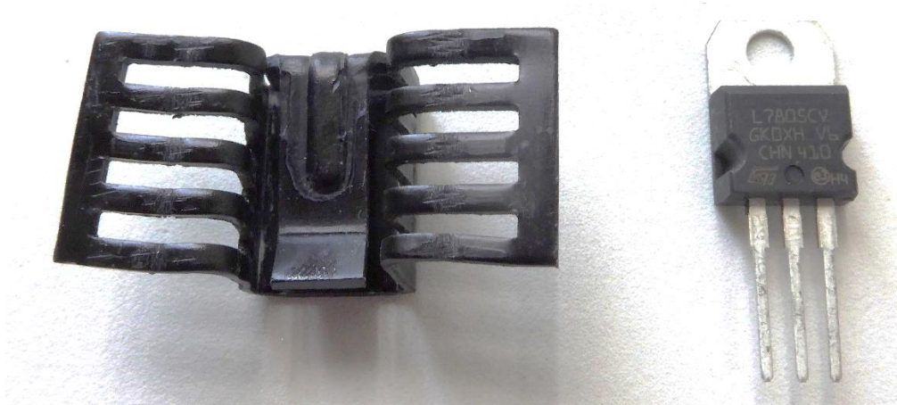
Figura 7. A la izquierda: imagen de un disipador de calor tipo clip para encapsulado TO-220. A la derecha: imagen de un regulador de voltaje en encapsulado TO-220 (Fotografía tomada por el autor).
