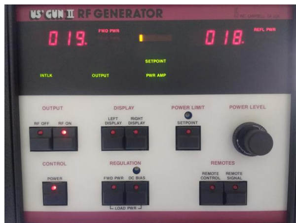
Figura 6. Panel del generador de RF, donde puede verse el mal acoplamiento de las impedancias.
