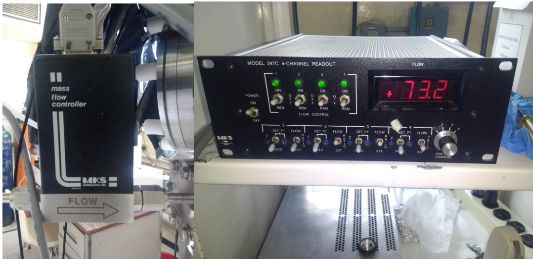
Figura 4. Controladores de masa y fuente de alimentación.
