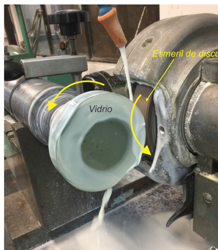
Figura 6. Redondeado del vidrio, en este proceso el esmeril avanza lentamente constantemente hacia el vidrio para devastar las esquinas hasta llevarlo a una geometría perfectamente redonda.
