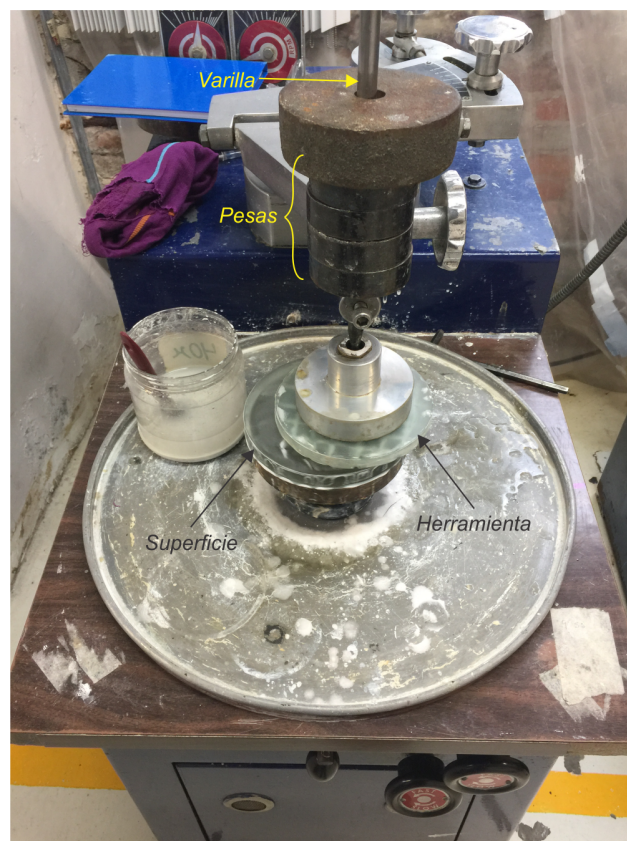
Figura 10. Imagen de una maquina utilizada para el esmerilado y pulido óptico tradicional.
