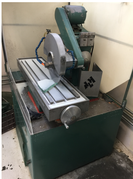
Figura 3. Imagen de la sierra eléctrica utilizada para el corte del vidrio en el Laboratorio de Manufactura de Componentes Ópticas del Instituto Nacional de Astrofísica Óptica y Electrónica (INAOE)
