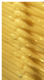
Figura 3.7 Costuras presentadas en una construcción FDM.
