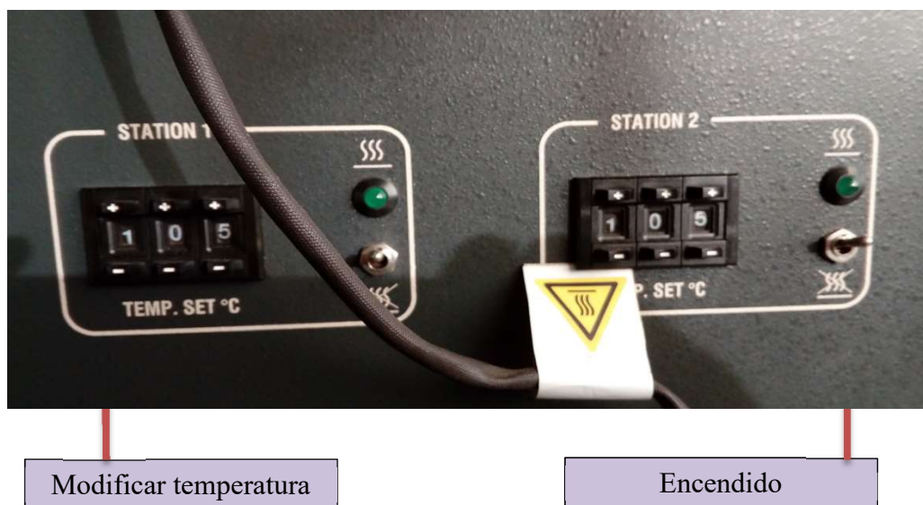
Fig. 5. Controladores de temperatura de las estaciones 1 y 2.
