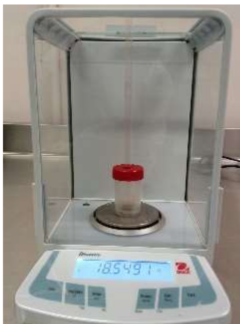
Fig. 3 Visualización de la forma en que la celda es pesada
