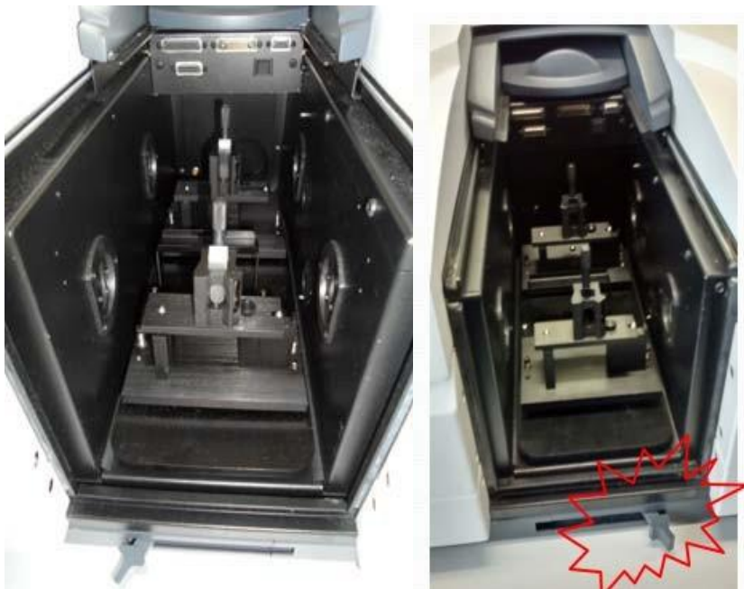
Figura 20. Mecanismo “Lock down” para sujetar el aditamento.
