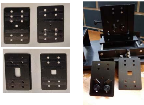
Figura 35. Ejemplos de portamuestras para películas con diferentes áreas de exposición.
