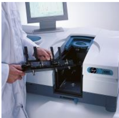
Figura 19. Forma en la que debe sujetarse y colocarse el aditamento.
