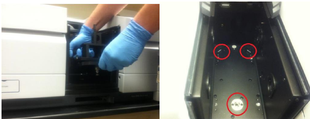
Figura 22. A) Aditamento de líquidos tomado por su manija para ser colocado en el compartimiento de la muestra del equipo y B) los orificios en la base del comportamiento de muestra.
