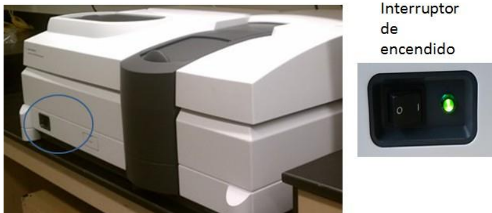
Figura 4. Interruptor de encendido del espectrofotómetro Cary 5000
