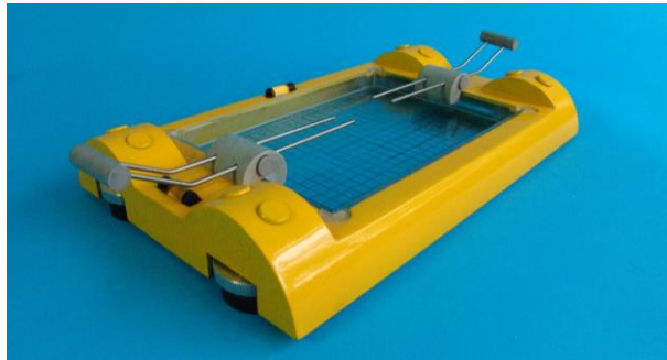
Figura 8. Los soportes constituidos de una base con forma de escalón, el botón de seguridad para fijar las guías y éstas que se deslizan a través de cada base.
