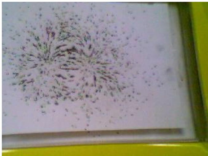
Figura 20. Fotografía del patrón de líneas de campo magnético producido con un imán y observado sobre papel colocado al fondo de la charola graficadora.
