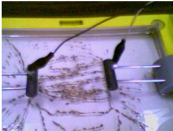
Figura 19. Fotografía de arreglo experimental para observar el patrón de líneas de campo.
