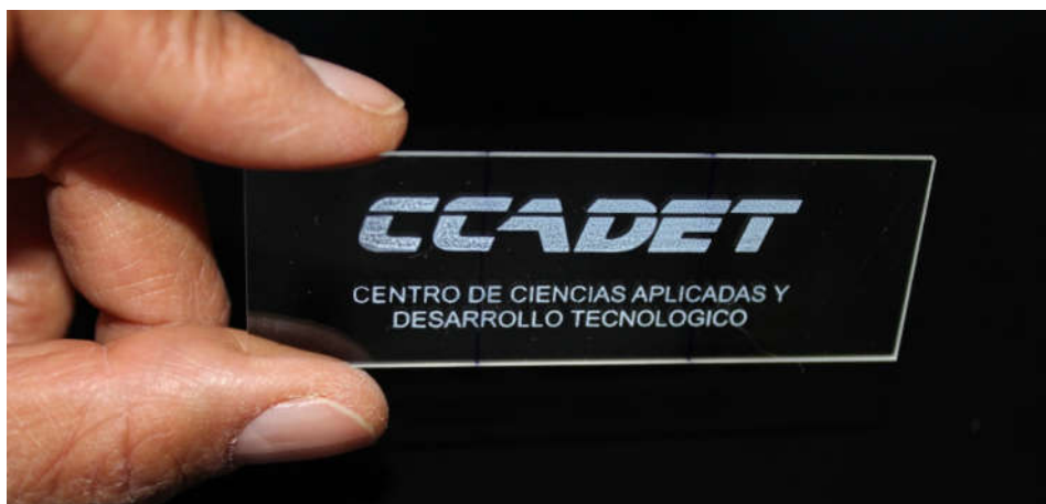
Figura 10. Depósito por serigrafía, 96 horas con esferas de \text{SiO}_2 .
