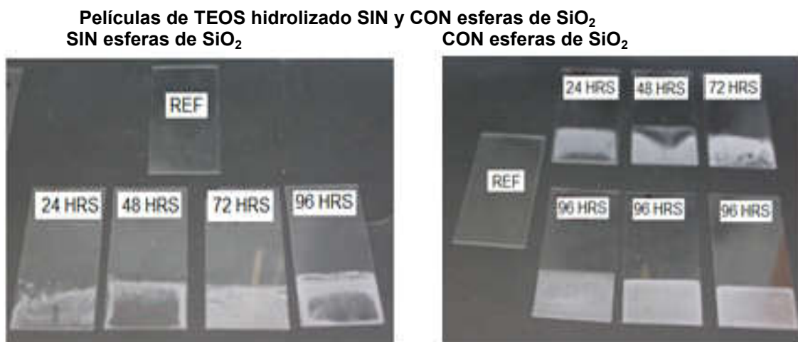
Figura 9. Sustrato de referencia, películas de TEOS hidrolizado SIN y CON esferas de SiO 2 , hechas a 24, 48, 72 y 96 horas de haber preparado las mezclas
