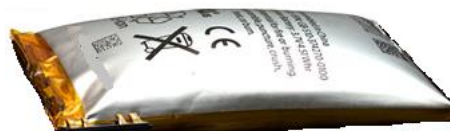
Figura 6. Batería de Litio dañada
