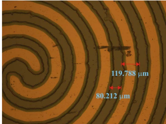
Figura 20. Medidas finales aproximadas de la impresión en acetato. (120 \mu\text{m} de ancho y 80 \mu\text{m} de separación entre electrodos)
