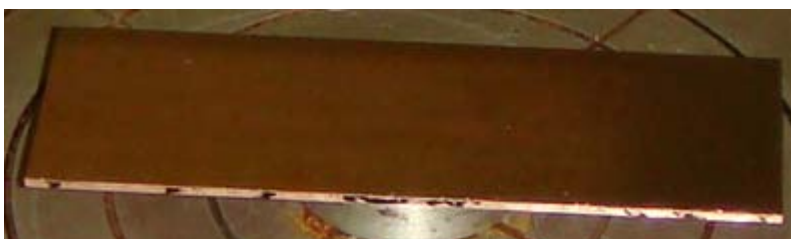
Figura 23. Sustrato de vidrio con recubrimiento de cobre sobre su superficie.
