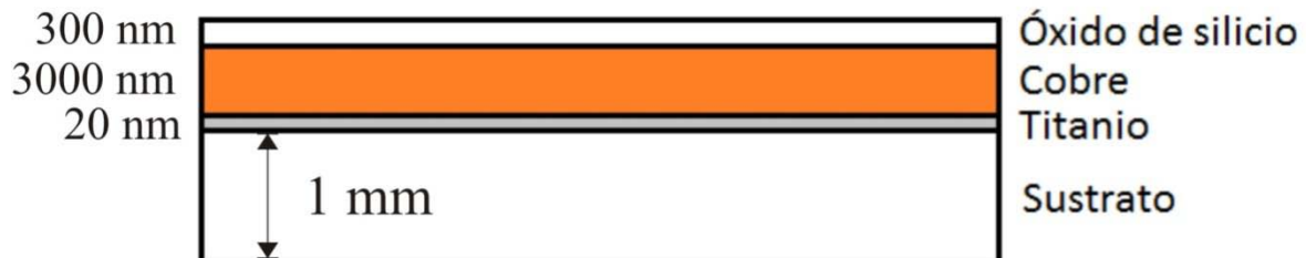
Figura 22. Representación de los depósitos sobre el sustrato dieléctrico.
