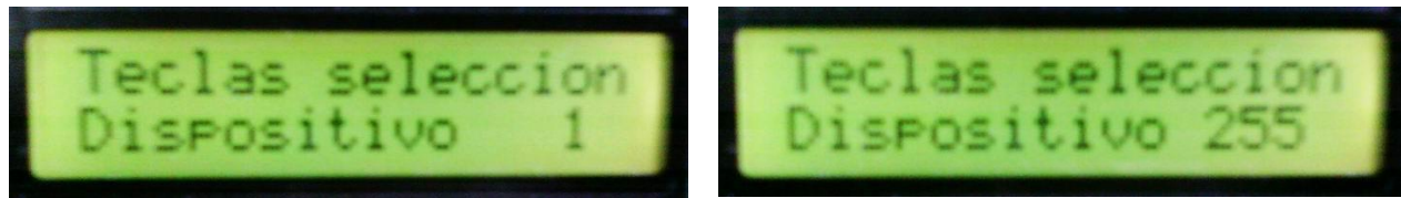
Figura 4. LCD muestra la dirección del control a utilizar.
