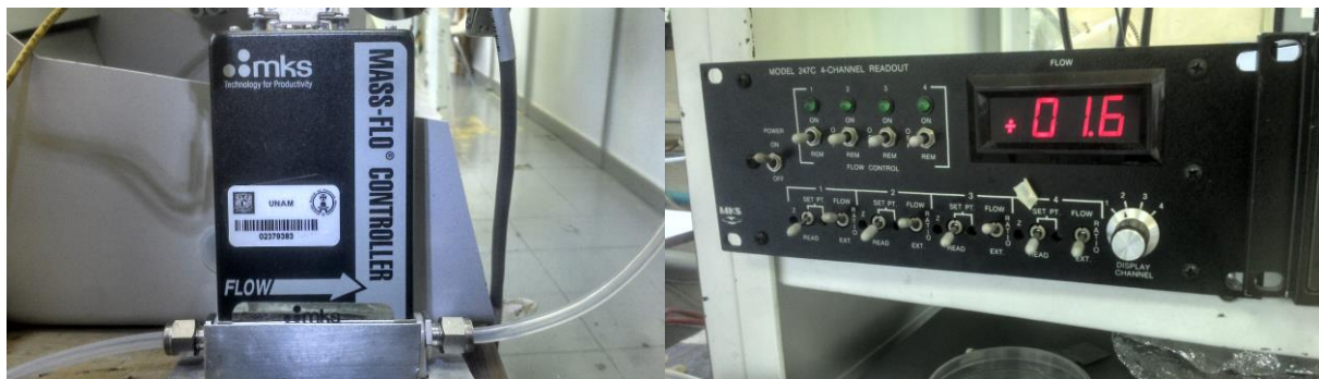
Figura 5. Controlador de masa MKS 1179A para ingreso de oxígeno y su fuente MKS 247C.
