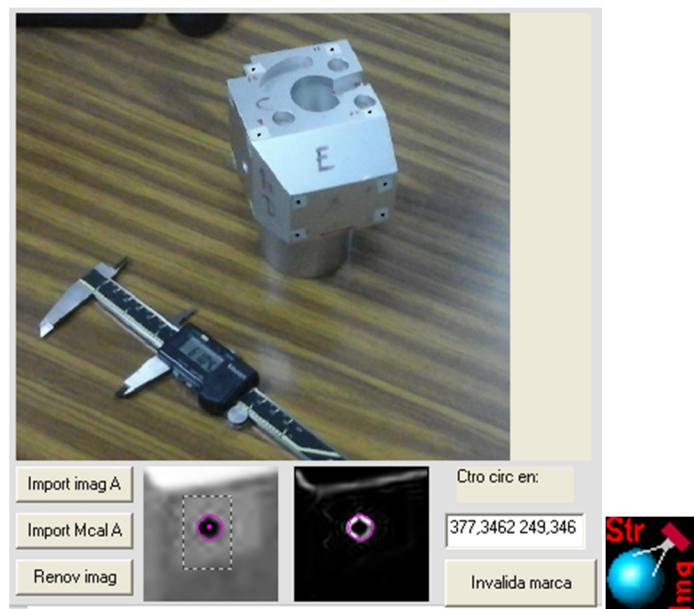
Figura 7.5. Segmento de la Interfaz de medición Str_Img que muestra: cubo u objeto a medir, vernier de verificación, comandos, selección de regiones (punto en esquina central), sub-imagen filtrada por contraste.
