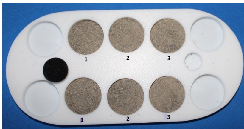
Figura 4.3. Ensayo 1 antes de la aplicación de TEOS.
