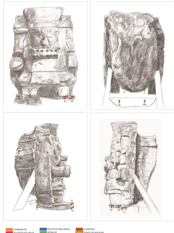
Figura 1.23. Localización de sales sobre el monolito.
