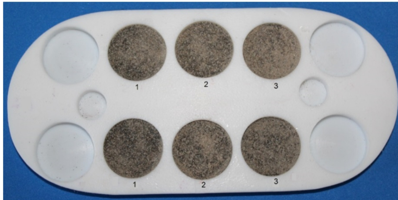
Figura 5. Andesita consolidada con 2 ml TEOS.
