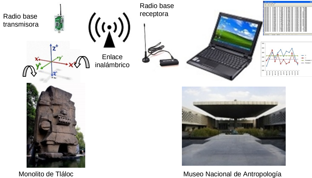
Figura 2.1. Arreglo experimental en la instrumentación del Monolito de Tláloc.
