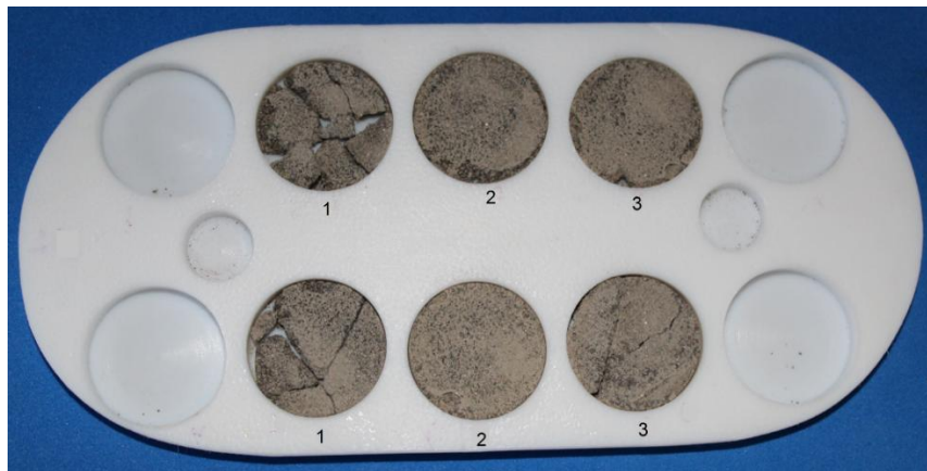
Figura 19. Imágenes de la vista posterior de las muestras secas, utilizando TEOS-48 horas.
