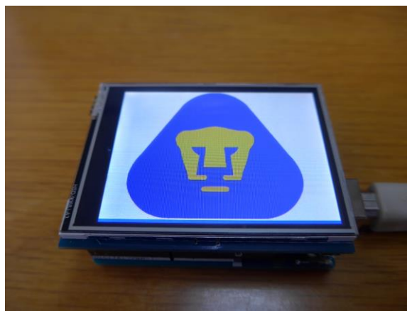
Figura 2. Pantalla de cristal líquido montada sobre la tarjeta Arduino UNO.
