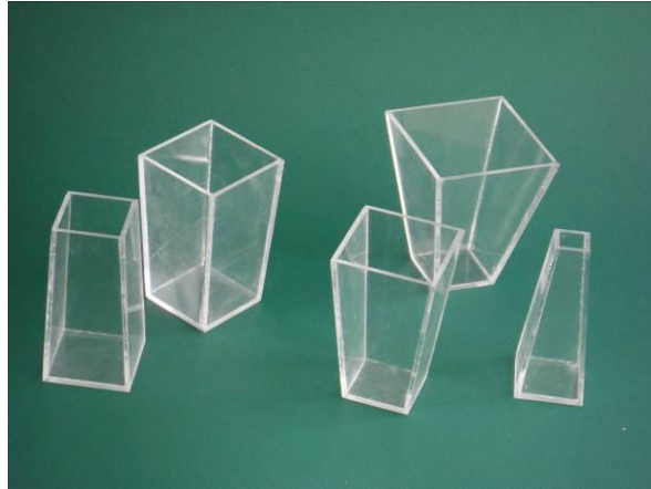
Figura 10. Fotos del juego de dos vasos de 87^\circ de inclinación y del juego de tres vasos de inclinaciones de 84^\circ y 79^\circ .
