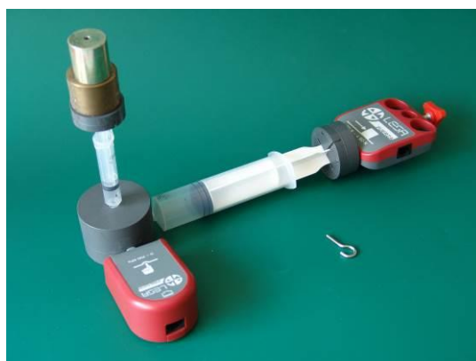
Figura 19. El conector de jeringas con un sensor de presión de LESA y dos jeringas, uno con una pesa y el otro empujado con un sensor de fuerza de LESA.
