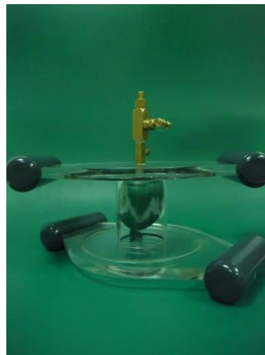
Figura 17. Bajando la presión en la cámara pequeña con agua para que hierva (arriba) e inflando un globo antes (abajo a la izquierda) y después de bajar la presión (abajo a la derecha).
