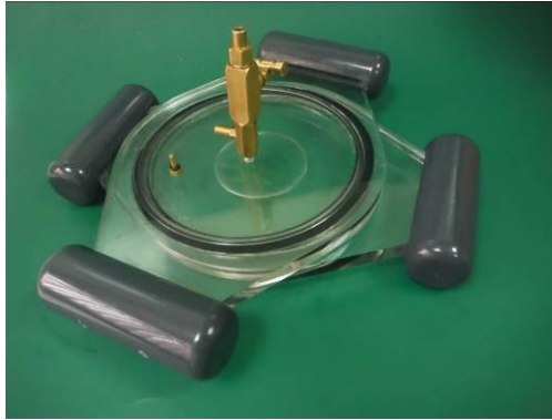
Figura 4. Las placas pueden funcionar como una cámara de área pequeña usando un o´ring chico en la cavidad de la placa inferior (foto izquierda) o como una cámara de área grande usando un o´ring grande en el canal de la placa superior y aprovechando la cara exterior de la placa inferior (foto derecha). La cámara de área grande se puede obtener con un empaque plano y aprovechando las dos superficies planas de las placas (abajo).
