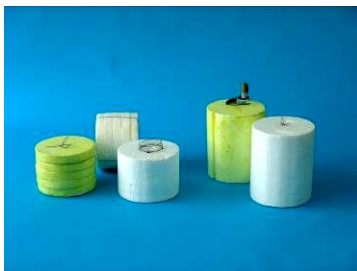
Figura 8. Cilindros de unicel en sus dos tamaños, puede ser de una pieza o estar formado por discos pegados y atados, así como estar sellado con pegamento blanco. A la izquierda los de 1.3 l, a la derecha los de 2.1 l.
