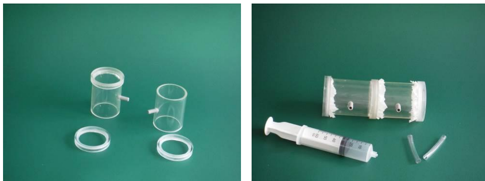
Figura 2. Cámaras de diferencia de presiones, (izquierda) piezas, (derecha) armado.
