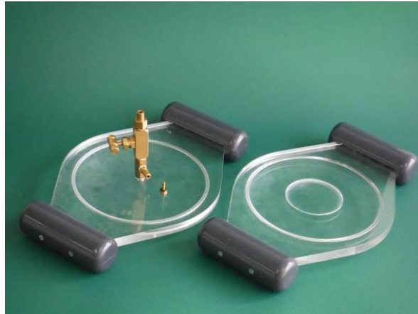
Figura 3. Las dos placas de Magdeburgo. A la izquierda la placa con la válvula externa, el tapón del conector al medidor de presión y el canal por la parte de abajo; y a la derecha la placa con el canal y cavidad pequeña los cuales están sobre la cara de arriba.
