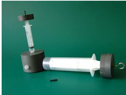
Figura 11. Conector de jeringas con dos jeringas insertados en dos barrenos, una de 60 ml y otra de 5 ml, ésta tiene un opresor milimétrico para que su émbolo sea empujado o jalado con un sensor de fuerza y el otro tiene una armella para ser jalado con un dinamómetro de resorte convencional, en el tercer barreno se muestra la punta de jeringa para conectar el sensor de presión del equipo LESA.
