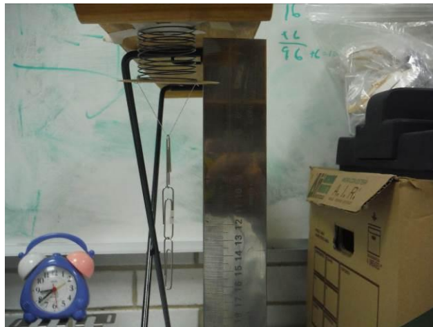
Figura A.1.1. Arreglo experimental para determinar el coeficiente de elasticidad de los resortes helicoidales.
