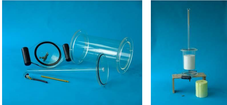
Figura 7. A la izquierda piezas de la cámara mayor con nueva tapa con tubo, tapón, pernos y nuevo resorte; a la derecha la cámara armada.
