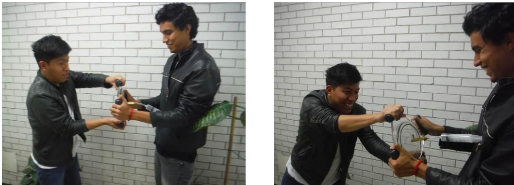
Figura 14. Placas de Magdeburgo a las que se le extrajo el aire: Arriba a la izquierda, las placas están conectadas al manómetro. Arriba a la derecha, Entre las placas hay un empaque plano y están conectadas a una bomba de vacío y un manómetro de mercurio. Abajo a la izquierda, las placas se jalan cuando se ha extraído el aire de la cámara de radio pequeño. Abajo a la derecha, y cuando se ha extraído el aire de la cámara de radio grande.
