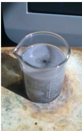
Figura 2.4 Lixiviación del contenido con ácido sulfúrico, pila alcalina.
