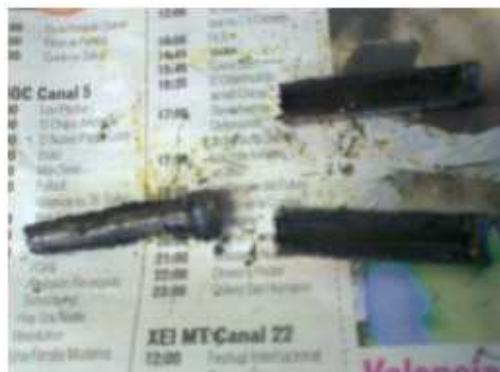
Figura 2.2 Desmantelamiento de una pila alcalina.
