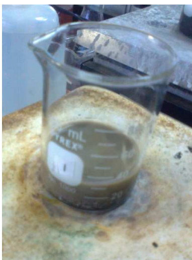
Figura 2.3 Separación del electrolito, pila alcalina.
