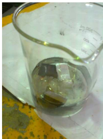
Figura 2.8 Separación del Electrolito de una pila Ion-Li
