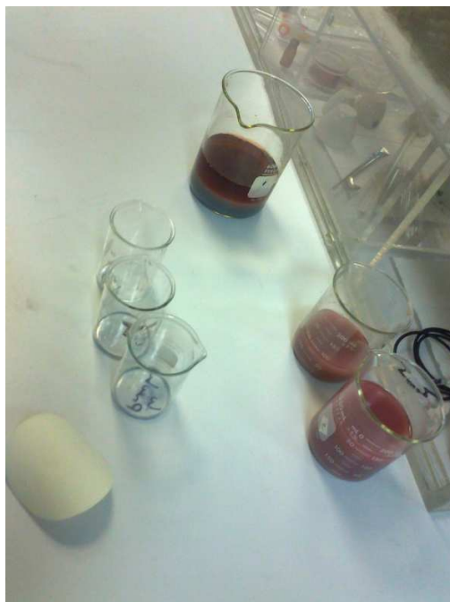
Figura 2.9 Lixiviación del contenido con ácido sulfúrico de una pila Ion-Li
