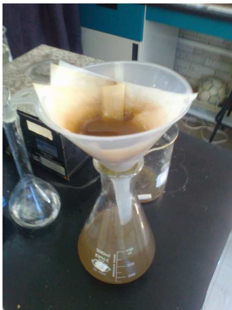
Figura 2.5 Obtención de \text{Zn}^{2+} y \text{Mn}^{2+} de una pila alcalina.
