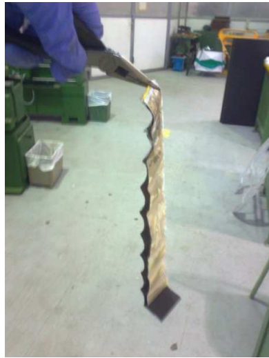
Figura 2.7 Desmantelamiento de una pila Ion-Li.
